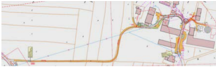
Synergien nutzen! Neben der neuen Wasserleitung, einem Straßenneubau inklusive Beleuchtung und Entwässerung wird die Strom-Freileitung von Bayernwerk im Erdreich verlegt.
