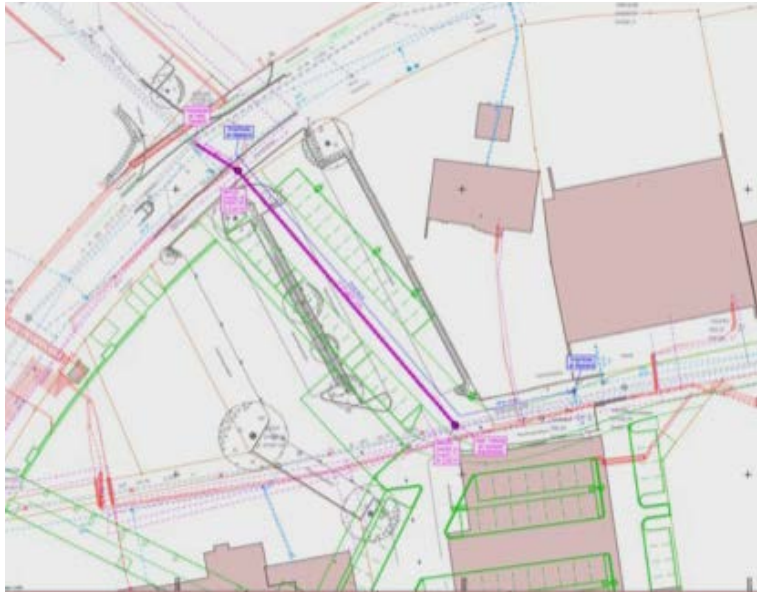
Umverlegung des Abwasserkanals zur Vorbereitung weiterer Baumaßnahmen am MunaPark.
