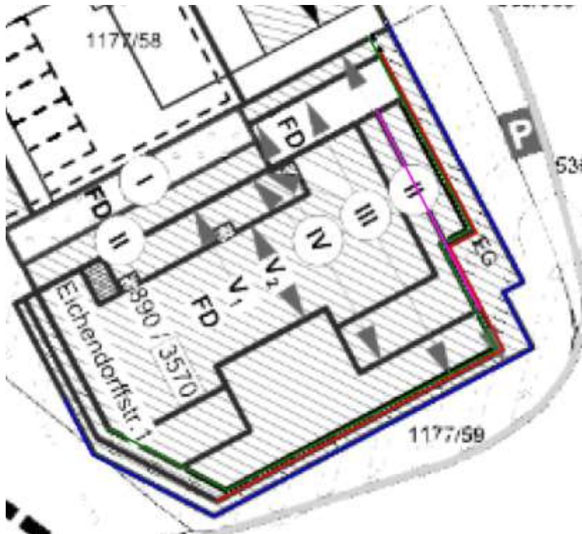
Abbildung 3: Lageplan mit Kennzeichnung der Fassaden(-abschnitte) auf dem Grundstück Fl.Nr. 1177/59, an denen Schallschutzmaßnahmen zur Tagzeit erforderlich sind
