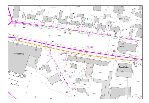
Um hier die Synergieeffekte gemeinsam mit der Baumaßnahme des Landkreises zu nutzen und spätere Probleme, z.B. evtl. nach dem Asphaltieren, zu vermeiden sowie zusätzliche Kosten zu sparen, wird von den Stadtwerken im Zuge dieser Tiefbauarbeiten ein alter Mischwasser-Steinzeugkanal DN 400 Baujahr 1956 der städtischen Kanalisation stillgelegt und verfüllt (im Bild gelb markiert).
