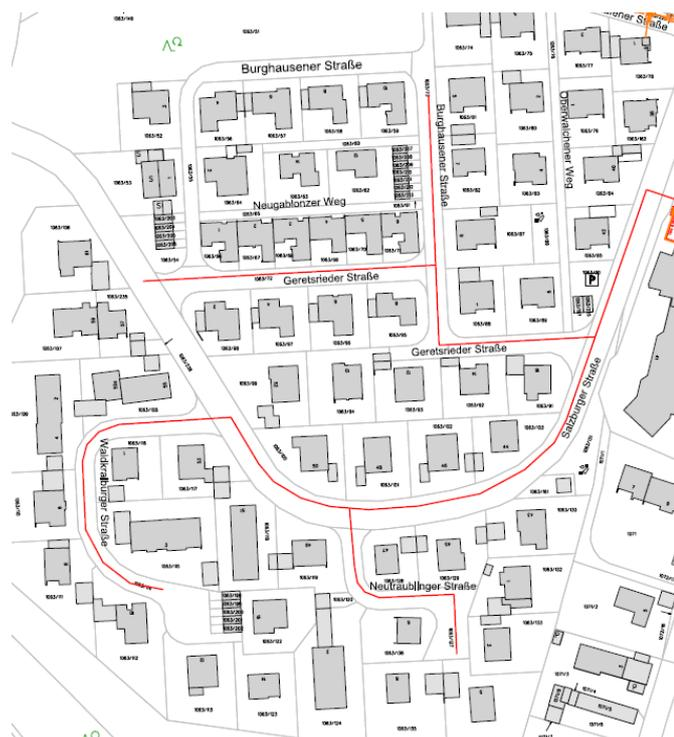
Daraufhin wurde eine FW-Trasse skizziert, die mit möglichst geringer Länge möglichst viele Gebäude anschließen soll. Mit der nun bekannten Länge der Haupt- und Anschlussleitungen konnten dann die erwarteten Baukosten ermittelt werden. Bei ca. 900 m Hauptleitung und ca. 400 m Hausanschlussleitungen liegen die Kosten bei ca. 900.000 EUR.
